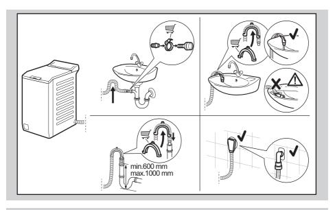
排水軟管高度必須在 600 mm、1000 mm。 排水軟管可以延伸至 4000 mm。請聯絡授權服務中心,取得更多排水軟管與延長部分。
