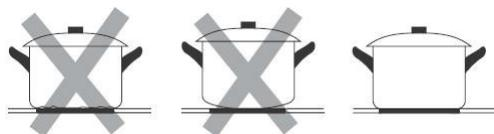
請確保你的鍋底平滑，能平穩地放在玻璃上，並且與烹飪區域大小相同。使用的鍋具直徑為所選擇的區域的圖形一樣大。使用鍋具稍寬闊，將能量使用其最大效能。如果使用更小的鍋，效能可能會低於預期。爐具底部直徑小於140毫米是不會被感應而不能使用。應放置鍋在煮食區域的正中心。
