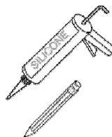
使用合適的工具將工作台切割成所需尺寸 (圖 1)。使用矽膠或聚四氟乙烯密封工作台的切割邊緣，並在安裝爐具前確保乾固。
