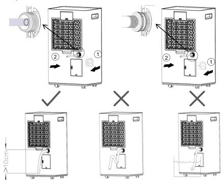
注意:外接水管不可過長(建議長度小於0.6米),水管末端高度 須低於機身排水口高度10釐米以上,水管要保持順暢,否則 可能無法正常排水。
