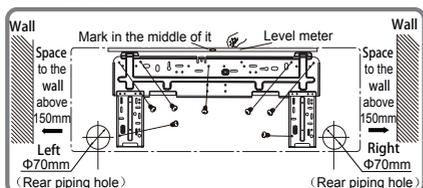
2. 在已選擇的去水管位置打開  $\Phi 55$  或  $\Phi 70$  直徑的管道孔。為了暢順地排水，把牆壁上的管孔向室外側略微向下傾斜  $5-10^\circ$  梯度。
