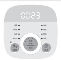
"功能/時間"旋鈕:在待機狀態下,旋轉旋鈕可依次選擇相應的功能:煨湯、肉骨湯、白粥、嬰兒粥、燉煮、燜燒、甜品、保溫,選定好功能後,對應指示燈閃亮,顯示屏顯示其默認工作時間,若無其他操作10秒後自動進入工作狀態,功能指示燈變為常亮;當選定好功能後,按下旋鈕,功能指示燈常亮,顯示屏顯示的時間閃爍,再次旋轉旋鈕可調節對應的工作時間,調節好時間後,再次按下旋鈕本機直接進入工作狀態,顯示屏顯示的時間變為常亮。若調節好時間後,無其他操作10秒後自動進入工作狀態。
