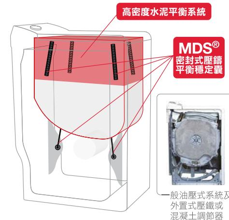
油壓式系統，只能減低上下擺動的震動，而白朗MDS®專利避震系統能把震動全方位轉移，達至徹底避震效果，不但減少噪音，操作時更加穩定。機件受全方位保護，減少組件損耗。
